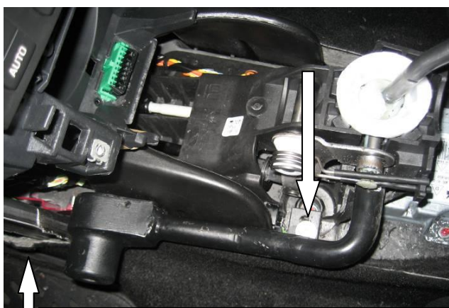
Установить замок, закрутить 2 болта
