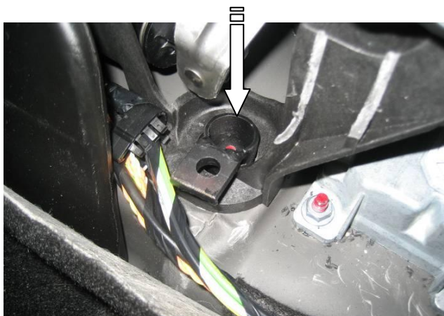
Установить деталь-переходник на шпильку
