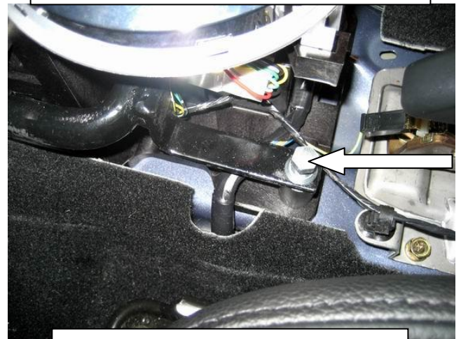
Подложить столбик под лапку замка, закрутить срывной болт
