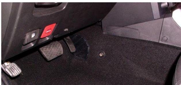
Разметить отверстие под цилиндр замка, используя разметочный шаблон, просверлить отверстие в ковровине, установить ковровину на место
