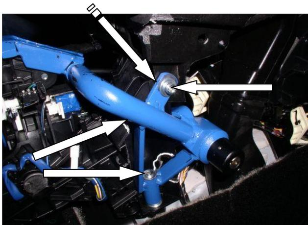
Установить замок, подложить под лапку столбик 5 мм., закрутить 3 срывных болта
