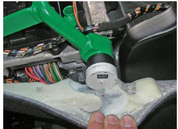
Удалить мешающую звукоизоляцию, разметить, используя разметочный шаблон, отверстие в ковровине под корпус замка
