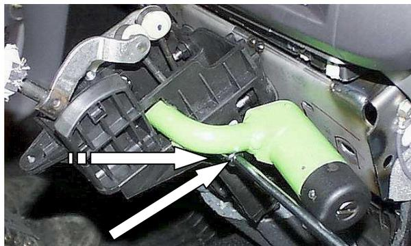
Открутить штатный болт селектора, установить замок трубой в отверстие, зафиксировать лапку замка на селекторе срывным болтом и несрывной гайкой с обратной стороны
