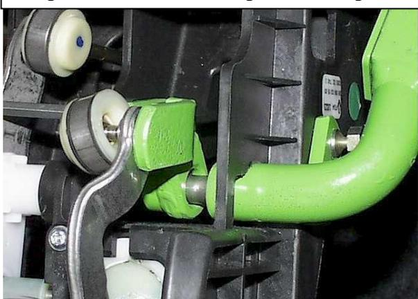
Перевести рычаг переключения передач в положение «R», произвести блокировку, отрегулировать положение хомута на тяге
