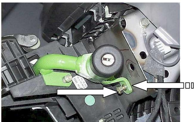
Открутить штатный болт селектора, зафиксировать лапку замка на селекторе срывным болтом и несрывной гайкой с обратной стороны
