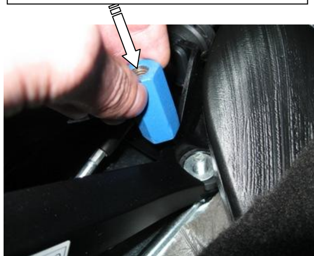
Установить шестигранный столбик на шпильку
