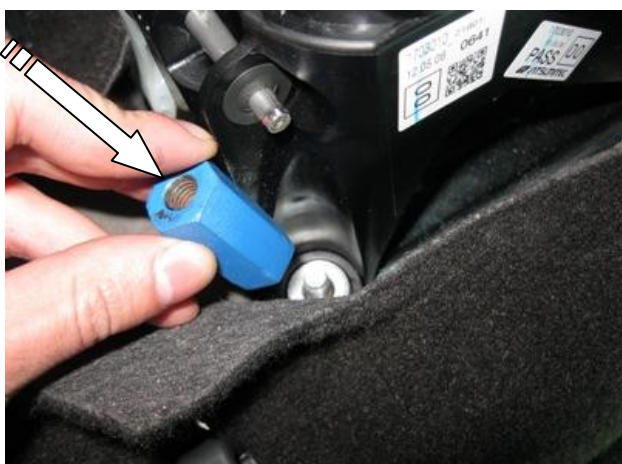
Установить шестигранный столбик на шпильку
