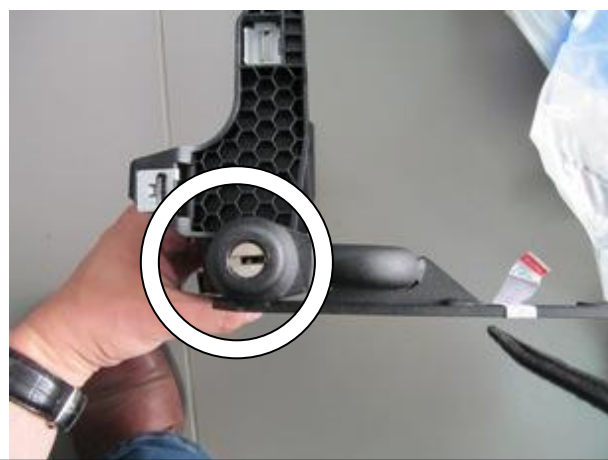
Разметить по замку и удалить мешающий пластик держателя консоли
