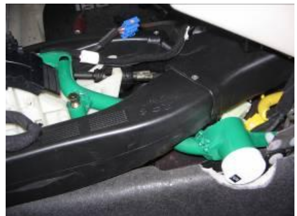
Разметить, используя разметочный шаблон, отверстие в консоли под корпус замка Установить защиту ригеля на трубу замка, зафиксировать винтом
