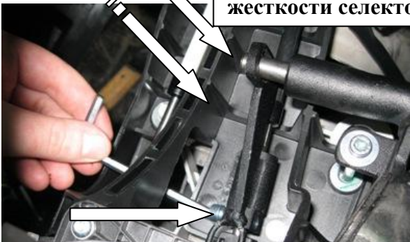
Установить хомут на тягу, зафиксировать винтом, перевести рукоятку рычага переключения передач в положение «R», произвести блокировку, отрегулировать положение хомута на тяге (подожмите «устье» хомута для надежной фиксации хомута), сорвать винт
