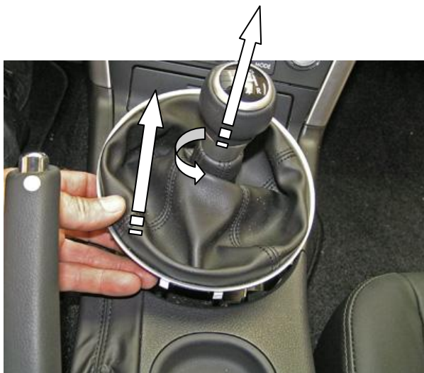
Открутить и снять рукоятку рычага переключения передач Снять декоративный чехол рычага
