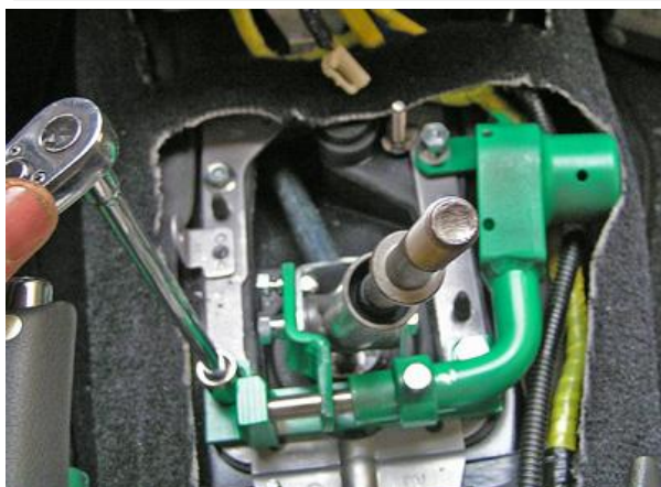
Перевести рычаг переключения передач в положение «R», произвести и проверить блокировку рычага
