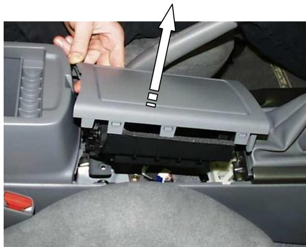
Снять верхнюю крышку
