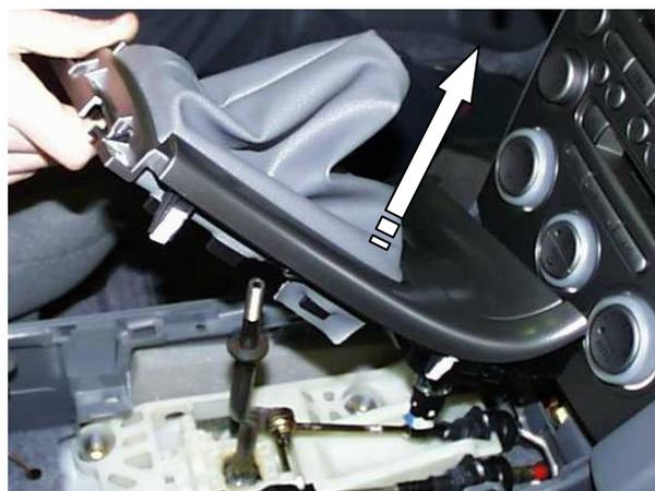
Снять верхнюю декоративную крышку
