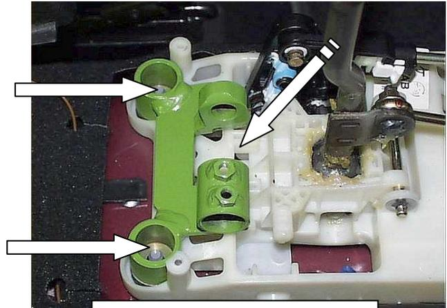
Установить кронштейн замка, закрутить 2 гайки
