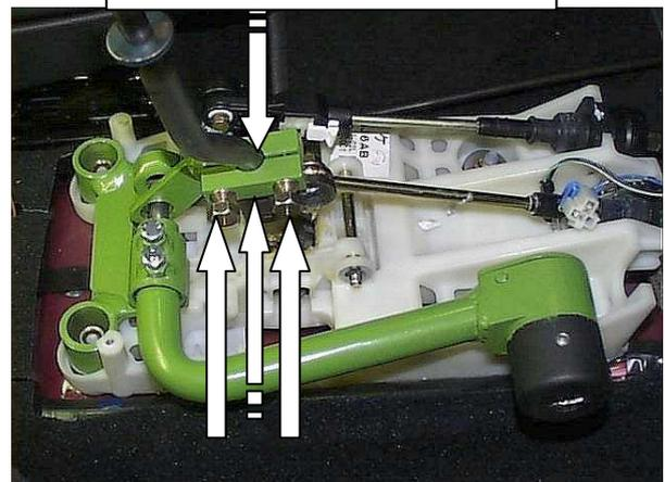
Установить хомут на рычаг переключения передач, зафиксировать
