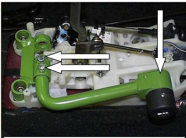
Установить замок, закрутить гайку, зафиксировать трубу замка в кольце кронштейна
