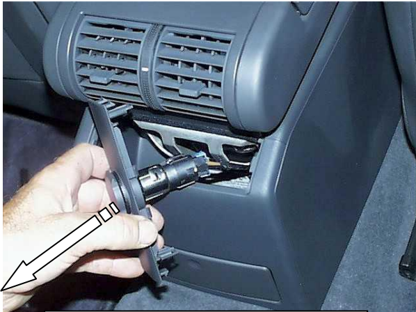
Снять крышку, разъединить разъём прикуривателя
