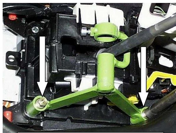
Установить кронштейн замка, закрутить 2 срывных болта
