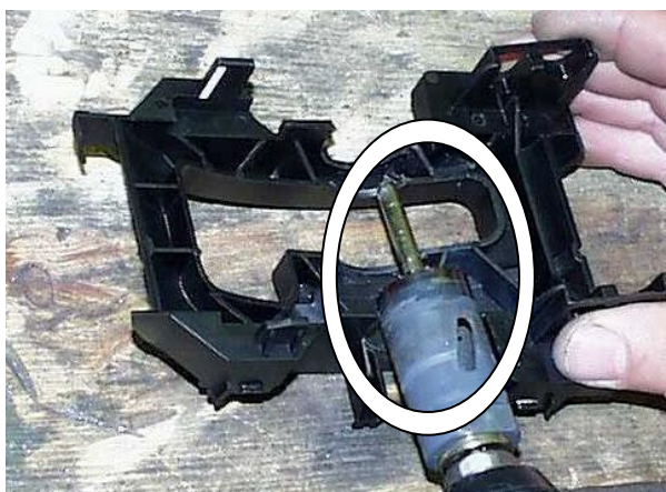
Просверлить отверстие в нижней панели селектора под кронштейн замка
