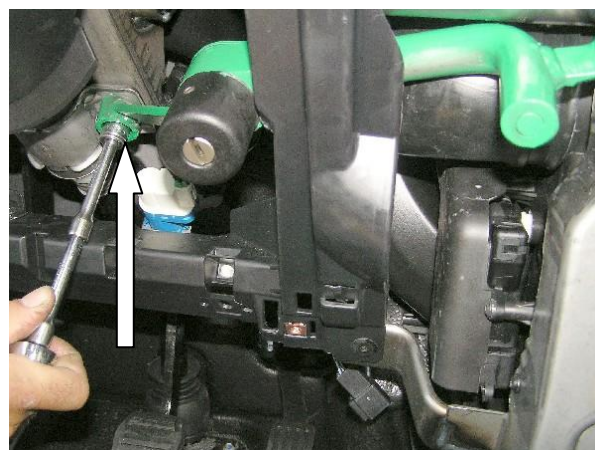
Установить замок на место, зафиксировать лапку замка срывной гайкой
