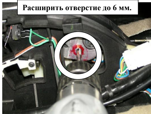
Просверлить в пластине отверстие по разметке
