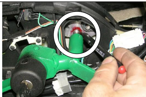
Разметить отверстие в детали по ригелю замка
