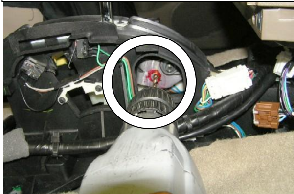
Просверлить в пластине отверстие по разметке
