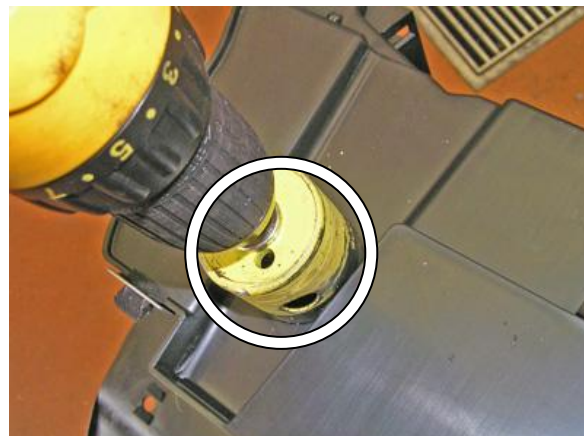
Просверлить отверстие во внутренней части консоли под корпус замка, собрать консоль
