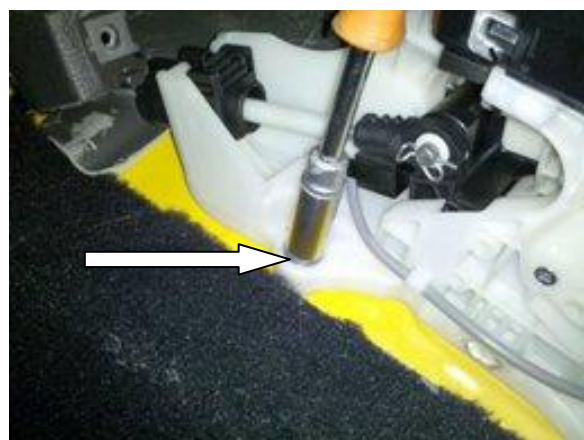
Открутить штатный болт селектора
