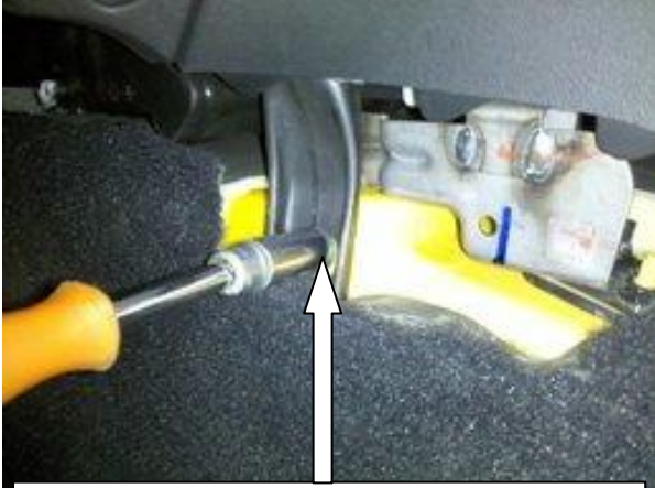
Открутить штатный болт селектора
