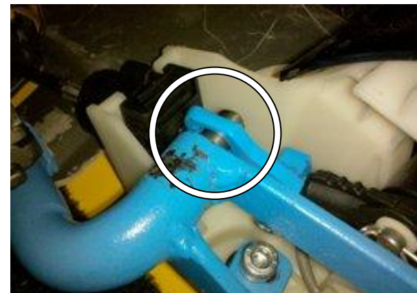
Перевести рычаг переключения передач в положение «Р», произвести блокировку, при необходимости отрегулировать положение хомута на тяге, сорвать винт
