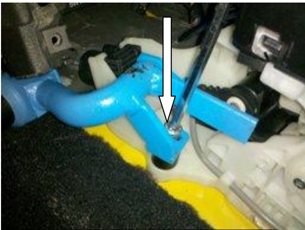
Установить замок на столбик, закрутить срывной болт
