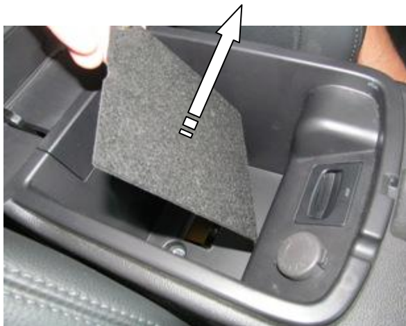
Поднять подлокотник, снять декоративную прокладку
