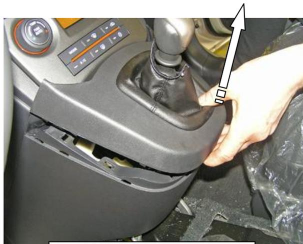
Снять верхнюю крышку
