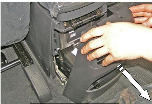
Снять заднюю панель
