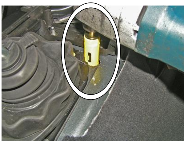
Расширить отверстие до 22 мм.
