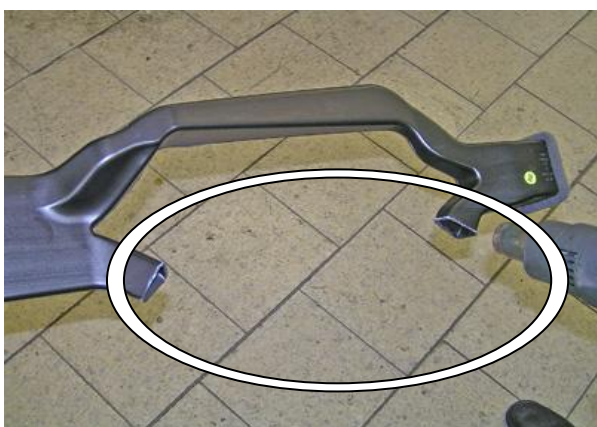
Нагреть феном и сплющить концы воздуховода
