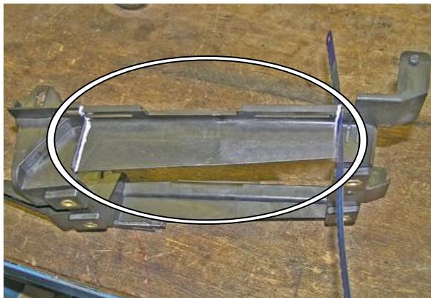
Удалить мешающий пластик держателя консоли
