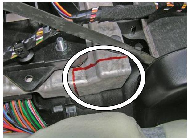
Удалить мешающий пластик селектора
