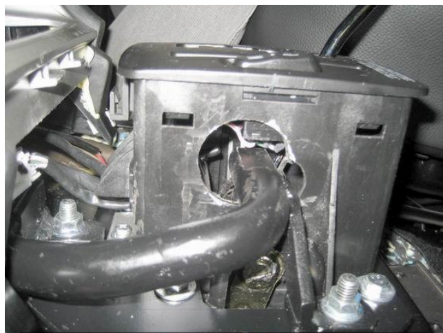
Перевести рычаг переключения передач в положение «Р», произвести и проверить блокировку
