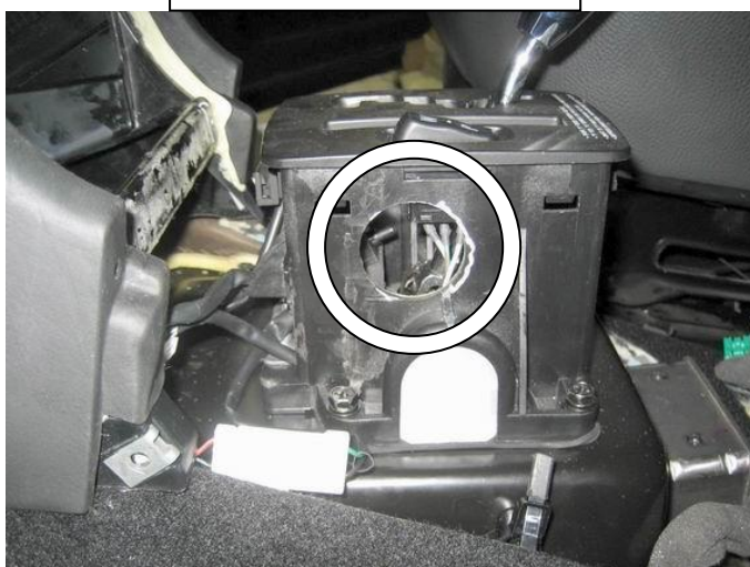
Просверлить отверстие в селекторе под трубу замка
