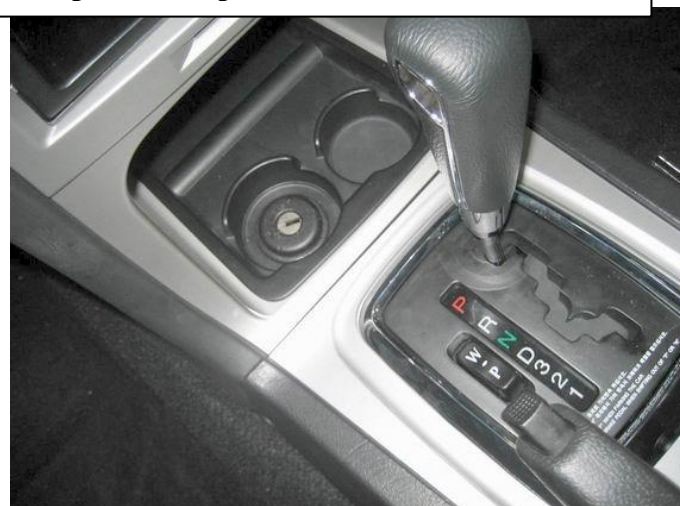
Разметить, используя разметочный шаблон, просверлить и расширить отверстие в блоке подстаканников, собрать консоль
