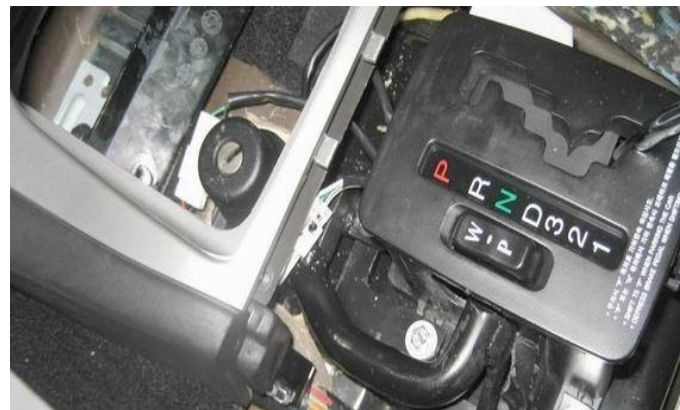
Установить кронштейн замка, зафиксировать 3 срывными болтами. Установить замок на шпильки кронштейна трубой в отверстие, зафиксировать 2 срывными гайками.
