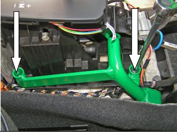
Установить замок, закрутить 2 гайки
