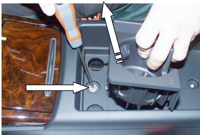
Снять подстаканник, открутить саморез
