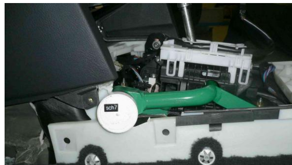
Разметить, используя разметочный шаблон, отверстие в боковой крышке под корпус замка
