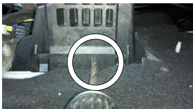
Просверлить отверстие в селекторе под трубу замка
