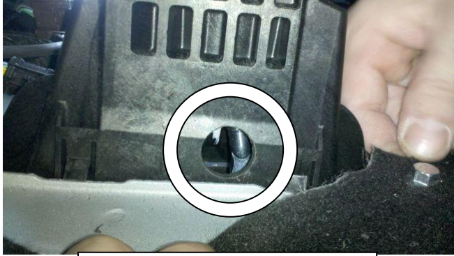
Точка блокировки (рычаг переключения передач)
