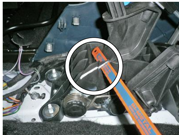
Удалить мешающий установке замка пластик селектора
