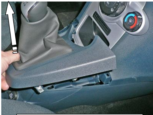
Снять декоративный кожух рычага переключения передач
