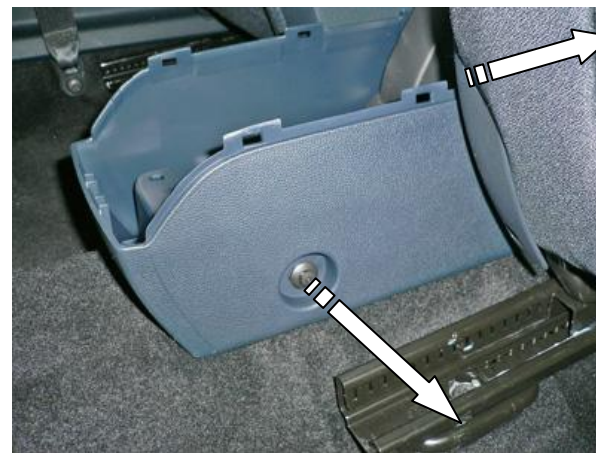
Сдвинуть передние кресла вперёд, вынуть клипсы с обеих сторон
