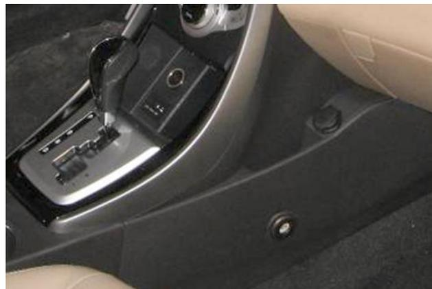
Разметить, используя разметочный шаблон, и просверлить в консоли отверстие под корпус замка, установить консоль на место
