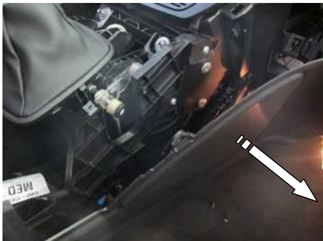
Снять боковые крышки с обеих сторон
