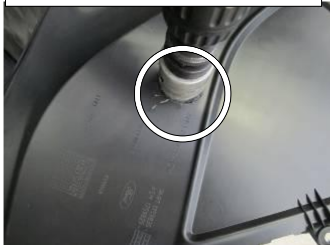
17 Просверлить и расширить отверстие
