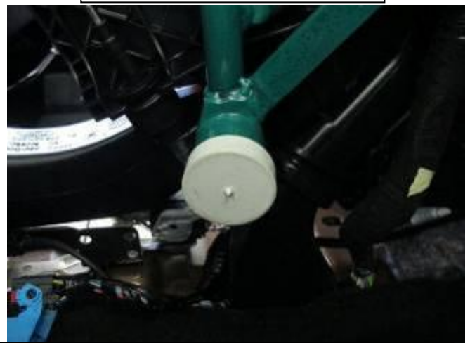
16 Разметить, используя разметочный шаблон, отверстие в консоли под корпус замка
