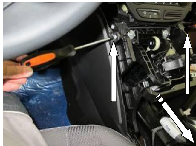
Открутить 2 самореза, снять консоль
