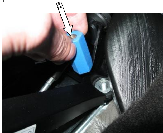
Установить шестигранный столбик на шпильку
