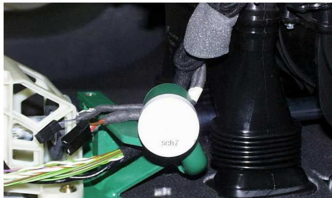
Разметить отверстие в консоли под корпус замка, используя разметочный шаблон
