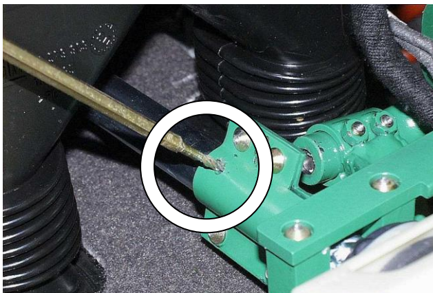
Просверлить отверстие в тяге через хомут
