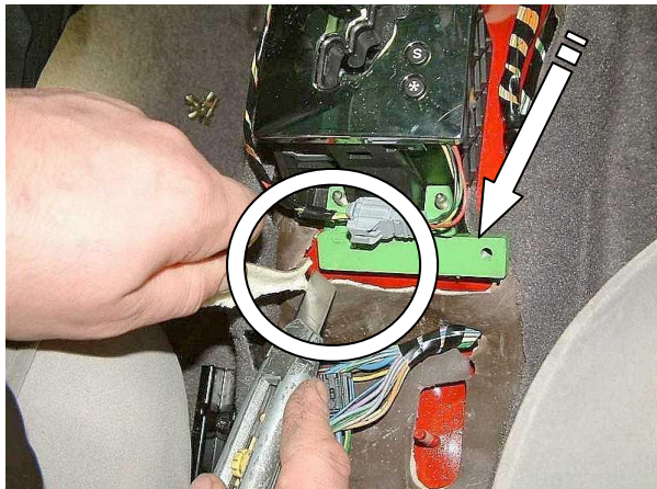
Удалить мешающий ковролин, установить деталь-переходник на шпильки
