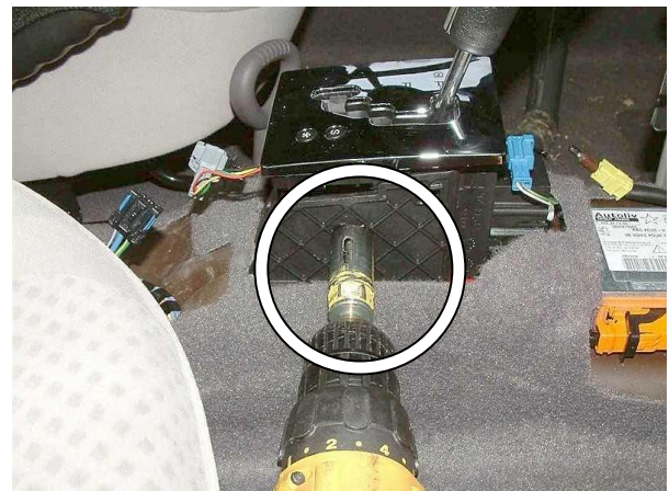
Просверлить отверстие 22 мм. в селекторе под трубу замка
