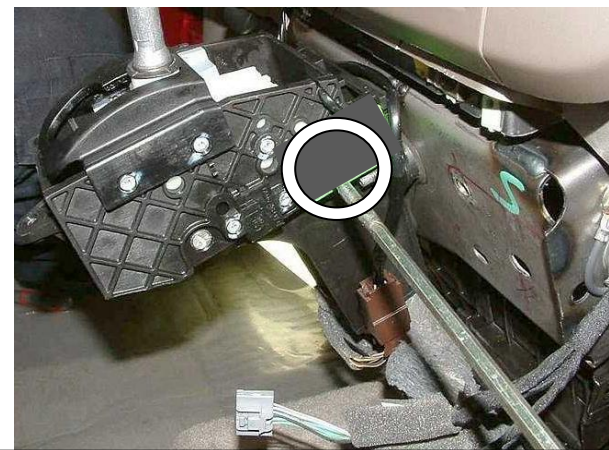
Просверлить отверстие в селекторе под трубу замка
