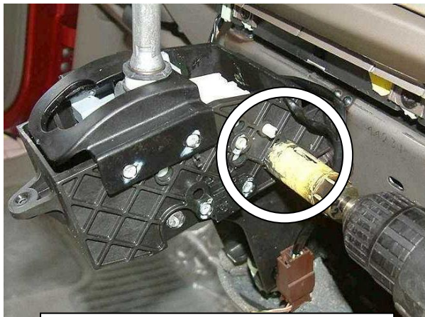
Расширить отверстие до 22 мм.
