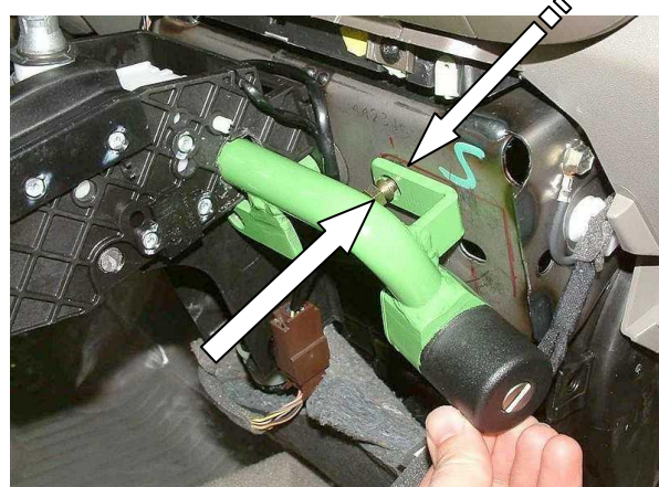
Установить замок трубой в отверстие, зафиксировать лапку срывным болтом и несрывной гайкой с противоположной стороны
