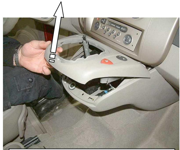
Снять верхнюю крышку селектора
