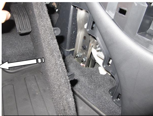
Снять боковые крышки с обеих сторон
