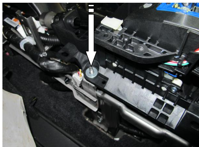
Подложить шайбы на шпильки
