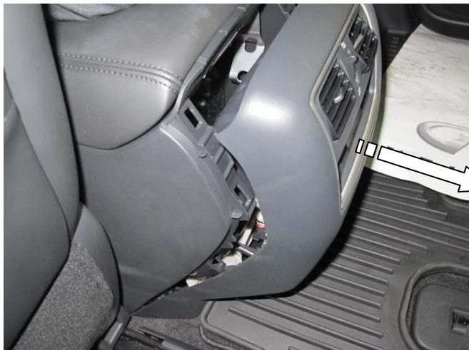
Снять заднюю крышку
